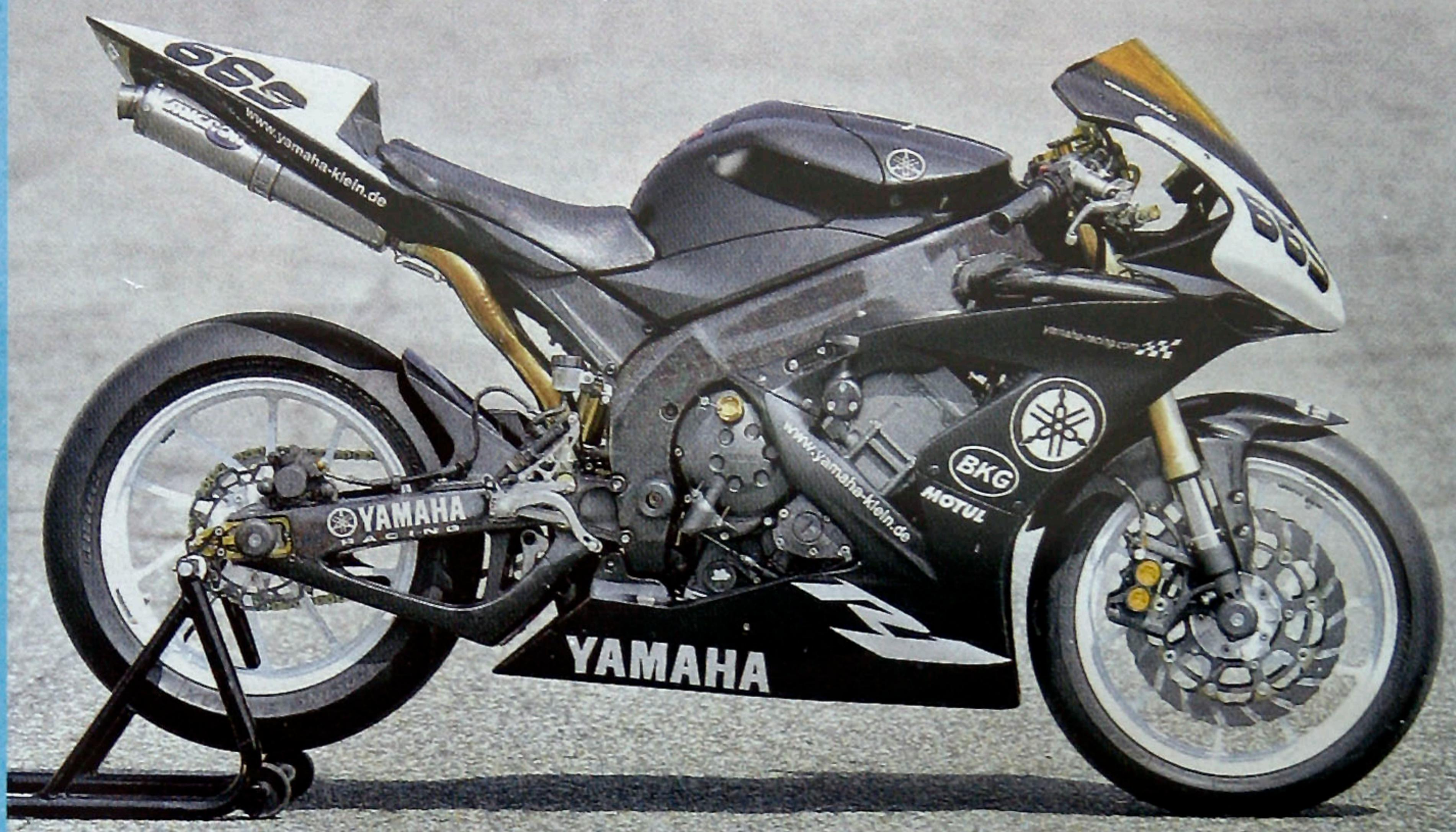
**Klein-Yamaha YZF-R1:** Hubraum 998 cm<sup>3</sup>, Leistung 178 PS, Drehmoment 109 Nm, umfangreiches Motortuning, Böckers-Wasserkühler, Braking-Bremsscheiben, Öhlins-Federbein, HH-Racetech-Gabelkit, BKG-Gabelbrücken, -Rosten, -Lenkerstummel, Galespeed-Schmiederäder, 194 kg fahrbereit, Preis 25 000 Euro
