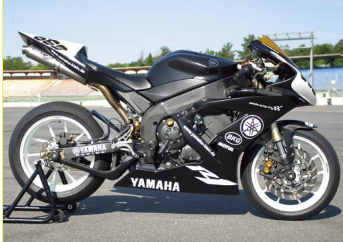
sen eine Kröpfung von 7,5 Millimeter auf, um die Gabel weiter durchstecken zu können. Dominik dazu: „Ziel war die Erhöhung des Schwerpunkts und eine damit einhergehende Änderung der Fahrzeuggeometrie. Das Gabel-Offset lässt sich, je nach Strecke und Fahrerwunsch zwischen -5 und +5 Millimeter um den Serienwert variieren. Bei der Lagerung des Lenkkopfes vertraute er wieder den Präzisionsla-
