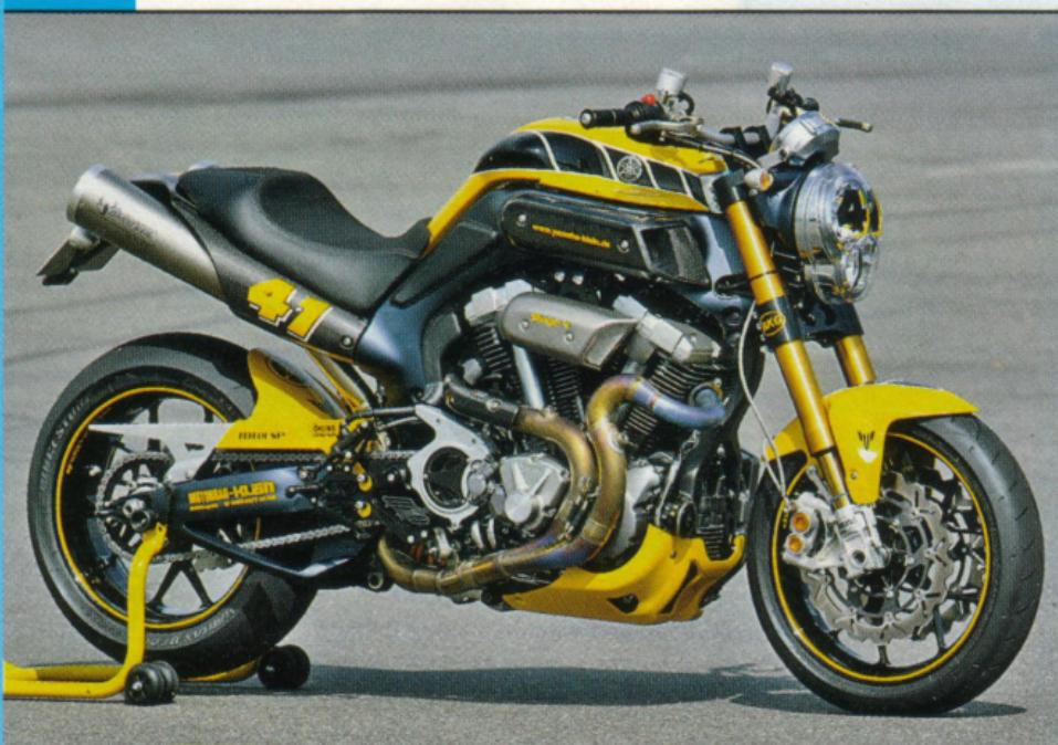
**Klein-Yamaha MT-01 „Stage 4“:** Hubraum 1670 cm<sup>3</sup>, Leistung 123 PS, Drehmoment 178 Nm, umfangreiches Motortuning basierend auf dem Stage 3-Kit, Akrapovic-Titan-Auspuff, Öhlins-Gabel und -Federbein, Geometrie geändert, BKG-Gabelbrücken, PVM-Schmiederäder, 247 kg fahrbereit, Preis 28 000 Euro
