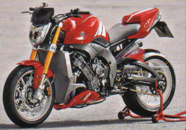
Klein-Yamaha FZ1: Hubraum 992 cm<sup>3</sup>, Leistung 185 PS, Drehmoment 116 Nm, Verdichtung 13,5:1, OVER-Titan-Auspuffanlage, Anti-Hopping-Kupplung, Dynojet-Power-Commander, Airbox überarbeitet, Galespeed-Alu-Schmiederäder, Galfer-Bremsscheiben, 200 kg fahrbereit, Preis 25 000 Euro
