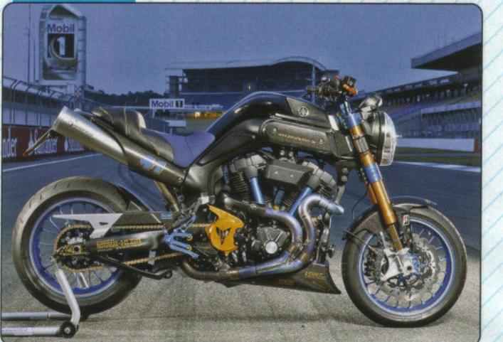
**Klein-Yamaha MT-01-R Stage 5:** Hubraum 1775 cm<sup>3</sup>, Leistung 130 PS, Drehmoment 195 Nm, Kit-Nockenwellen und -Ventilfedern, Zylinderkopf- und Kanalbearbeitung, geänderte Ventile, modifizierte Öhlins-Gabel mit BKG-Gabelbrücken und Öhlins-Zentralfederbein, PVM-Aluminium-Schmiederäder, Preis 28 000 Euro
