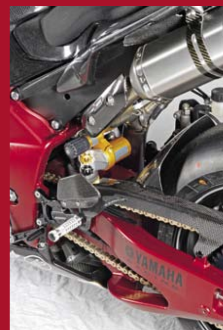
Perfekt abgestimmt arbeitet das TTX36-Federbein von Öhlins an der Hinterhand.
