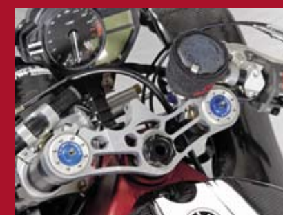
Die Gabelbrücken mit geändertem Offset sind formschön und steif.
