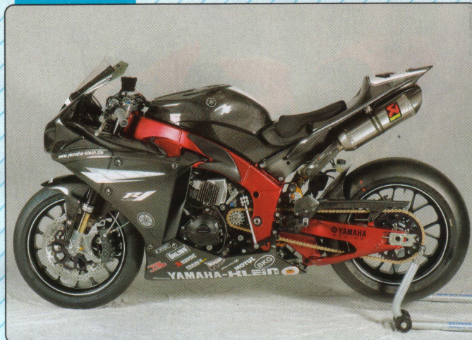
Klein-Yamaha YZF-R1: Hubraum 998 cm 3 , Leistung an der Kurbelwelle 191 PS, Drehmoment 112,6 Nm, Gewicht (vollgetankt) 187,7 kg, Zylinderkopftuning, Kit-Ansaugtrichter, Böckers-Kühler, Powercommander, Öhlins-Fahrwerk, BKG-Gabelbrücken mit variablem Versatz, Schmiederäder, Carbonverkleidung. Ca. 30 000 Euro
