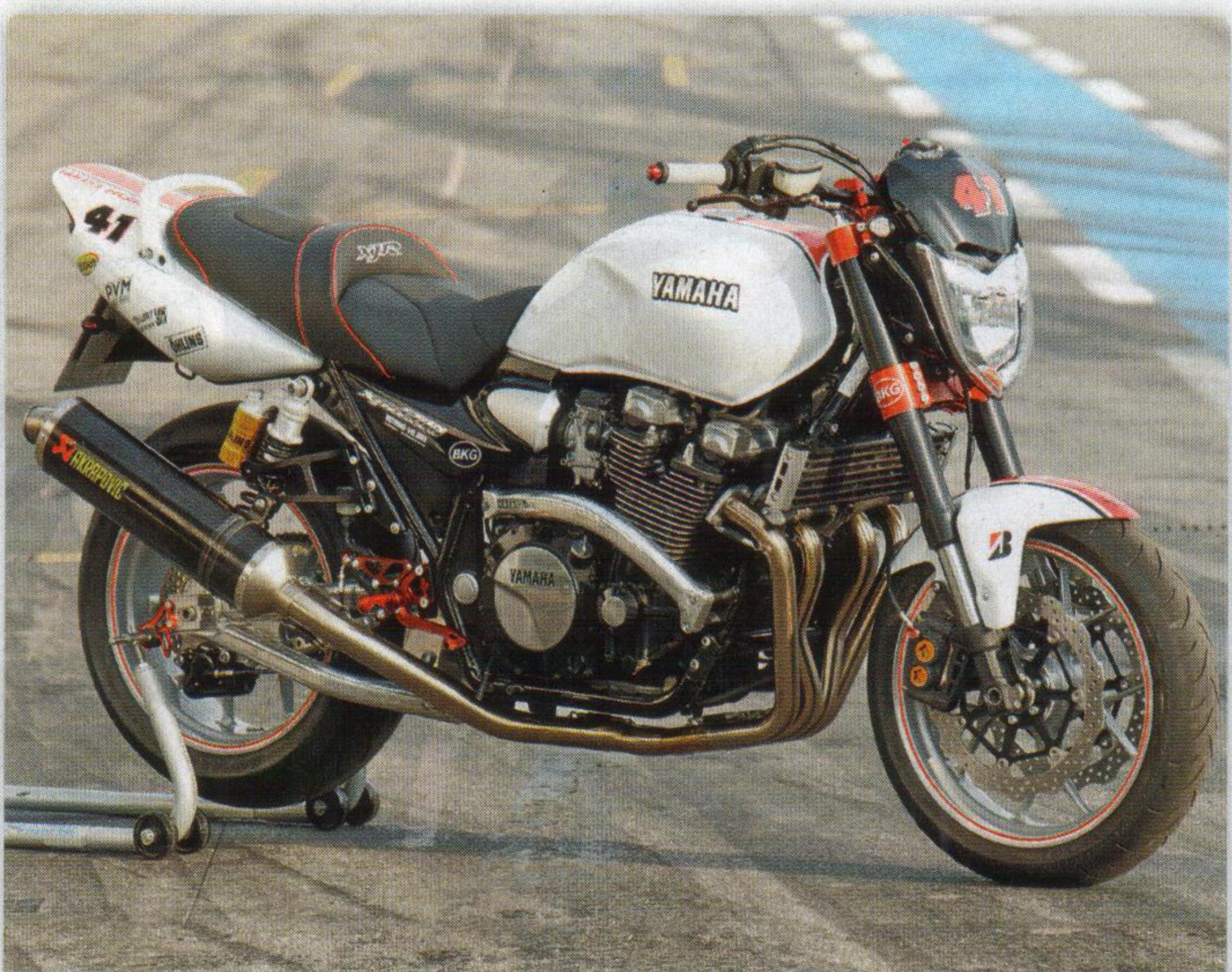
**Klein-Yamaha XJR 1300:** Vergaser-Kit, offene Ansaugstutzen, Akrapovic-Anlage, modifizierte MT-01-Gabel, Öhlins-Federbein, PVM-Alu-Schmiederäder, R1-Bremse vorn, Schwinge und Rahmenverstärkungen von Over, Schaltautomat, Stahlflex-Leitungen, ca. 15 000 Euro
