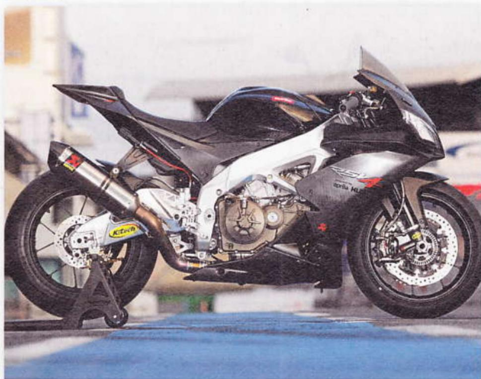
**Klein-Aprilia RSV4 Factory:** Motor serienmäßig, Peripherie und Kühlkreislauf Racing-optimiert, Rapid Bike Racing-Modul, Akrapovič-Auspuffanlage, K-Tech-Fahrwerk, BKG-Lenker, Magura-Bremspumpe, Brembo-Scheiben, -Sättel und -Beläge, Schaltautomat uvm.: ca. 35 000 Euro
