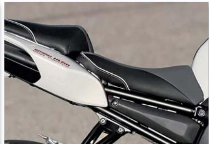
Die Zubehör-Sitzbank sieht zwar etwas schwulstig aus, dafür hebt sie die Sitzposition um zirka zehn Millimeter an. Dadurch sitzt der Pilot etwas mehr auf, statt im Bike
