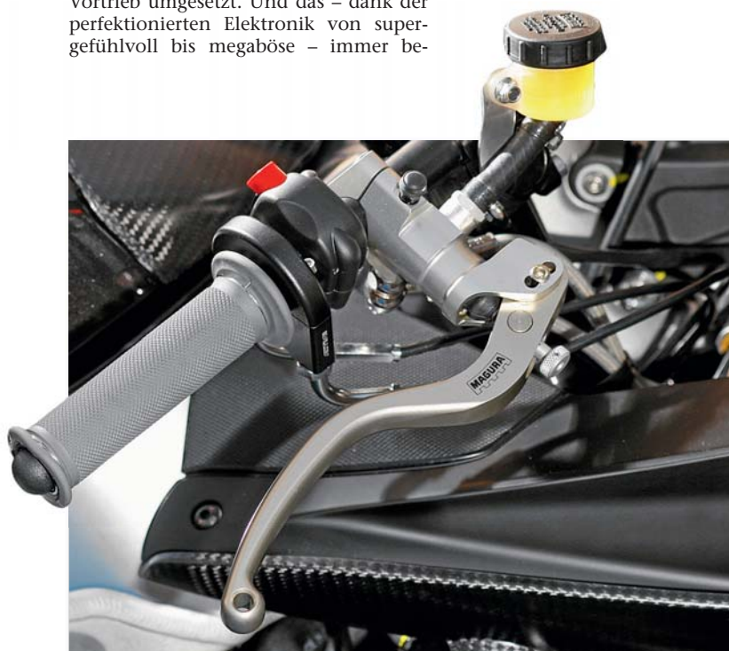
Aus dem Vollen gefräst: die Magura-Radialpumpe mit 20 Millimeter Kolbendurchmesser und variabler Anlenkung
