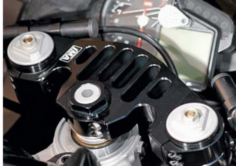
Stabil und ein Hingucker: die gefräste Gabelbrücke von IMA-Racing
