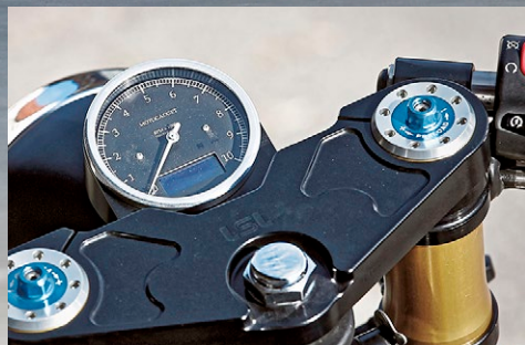
Alles LSL hier: Gabelbrücke und Lenkerstummel nämlich; einstellbare Öhlins-Gabel und Motogadget-Instrument
