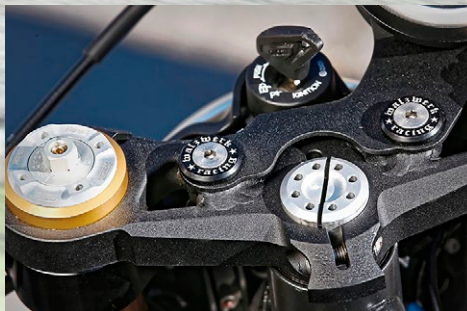
Auf der extremen Seite: 71 Grad Lenkkopfwinkel treffen auf ebensoviel (wenig) Millimeter Nachlauf. Das macht sehr agil
