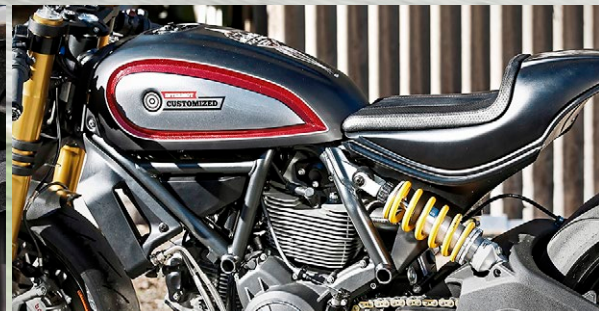
Edelst: zierlicher Höcker, Öhlins-Spezialfederbein in bearbeiteter Schwinge, Kupplungsnehmer nach links verlegt
