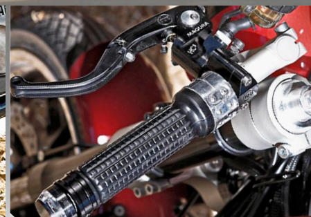
Feinste Ware: radiale Magura HC 3 -Kupplungs- und Bremspumpe, Griffe und „Tastaturen“ von Motogadget
