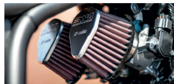
Verstellbare Hightech-Fußrastenanlage aus dem Yamaha-Zubehörprogramm (oben), offene DNA-Luftfilter (unten)
