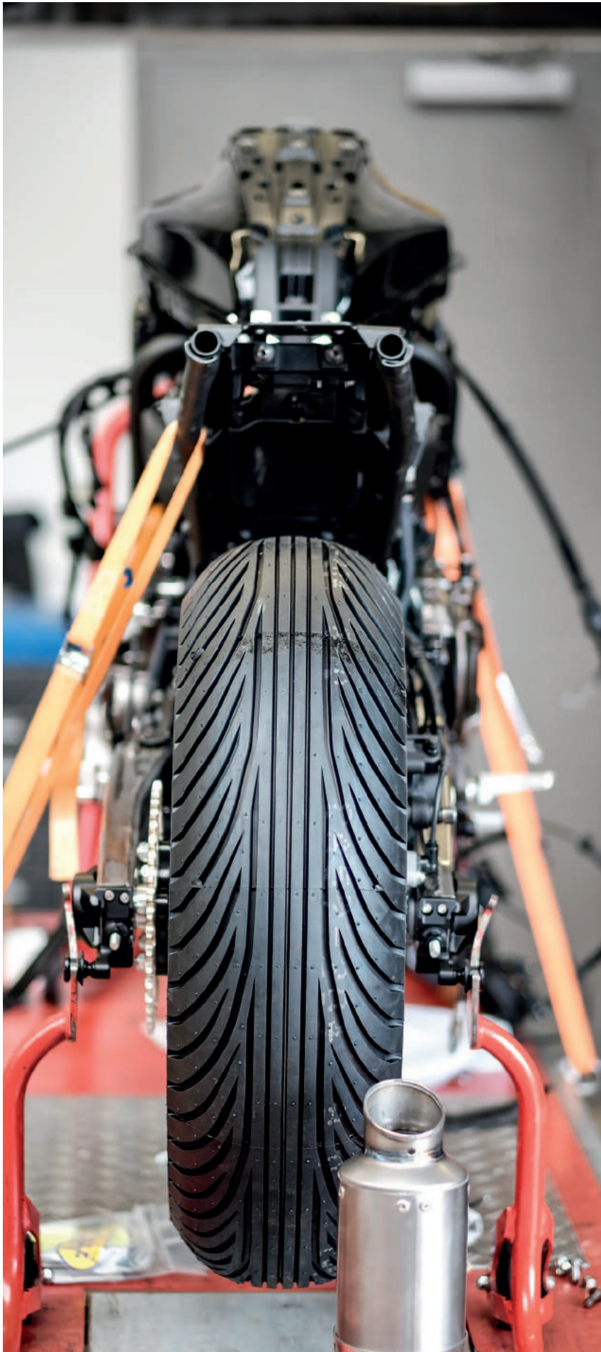
Die ungewöhnliche Profilierung kommt aus dem Rennsport. Die Yamaha XSR 700 rollt in Zukunft auf Racing-Regenreifen
