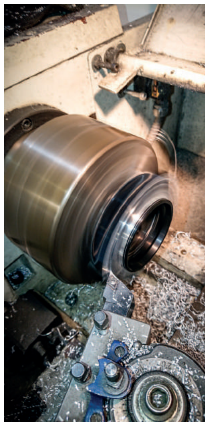
Nicht alles passt einfach so. Manche Teile müssen selbst hergestellt werden. Und so kommt auch die Drehbank immer wieder zum Einsatz
