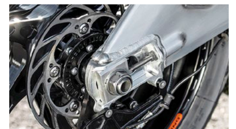
Spezielle Brücken für die stärkere Gabel (o.), an der Radachsaufnahme ausgefräste Serienschwinge
