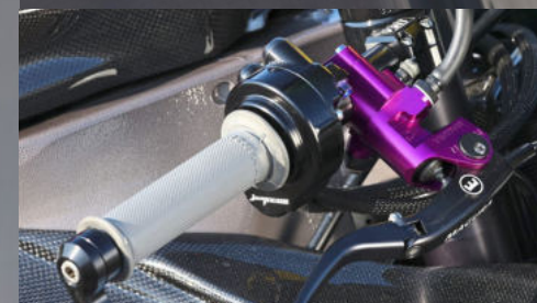
Maguras Edel-Anker HC3 in Kombi mit Brembo GP4-RR-Zangen beißt
