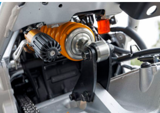
Das Öhlins-Dämpfwerk verhilft der Klein-XSR zu hoher Stabilität, viel Schräglagenfreiheit und Reserven
