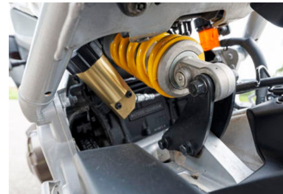
Das Federbein (mit Handrad für die Federbasis) hält dämpfungstechnisch mit der feinen Gabel mit
