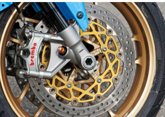
Brembo-Monoblocs (aus der MT-09 SP) beißen wirkungsvoll in HP-320-mm-Discs desselben Herstellers
