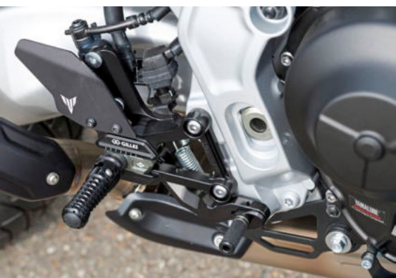
Gilles-Rastenanlage mit viel Stiefelgrip: Der Rastenkörper ist horizontal einstellbar (3 cm vor und zurück)
