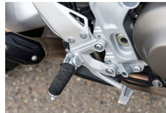
Zwei unterschiedliche Anschraubpunkte für die Rasten schaffen Varianz, die Gummierung wirkt billig
