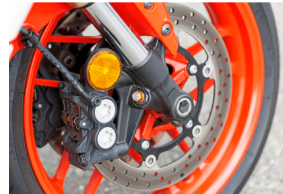
Vierkolben-Festsattel mit Yamahatypischen Staubkappen, dazu Gummileitungen – bremst sehr passabel
