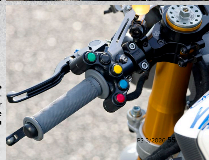
Achtung, der obere Hebel ist keine Kuppelung! Viele Racer lieben sogenannte Scooterbremsen
