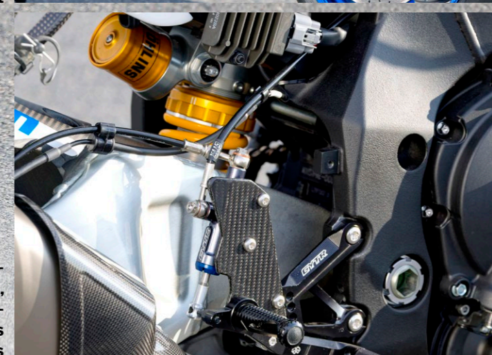
GYTR-Rasten, modifizierte R1M-Schwinge, angepasstes Öhlins-RSP40-Federbein als Highlight des Aufbaus
